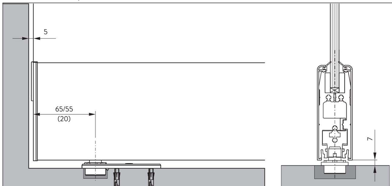
Fig. 4 Dimensioni con cuscinetto a pavimento
