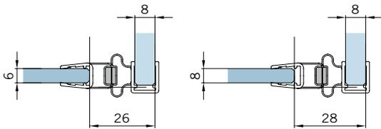
Magnetdichtung 90° für Pendeltüren,
