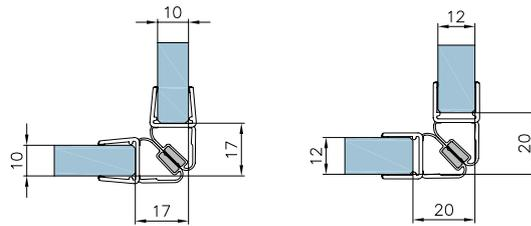
Magnetdichtung 135°, **Acryl transparent**, als 180°-Verbindung, für 6/8 mm Glas, Lieferung paarweise, 2.500 mm
