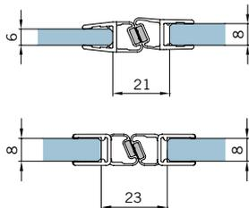
Magnetdichtung 135°, **Acryl transparent**, für 6/8 mm Glas, Lieferung paarweise, 2.500 mm
