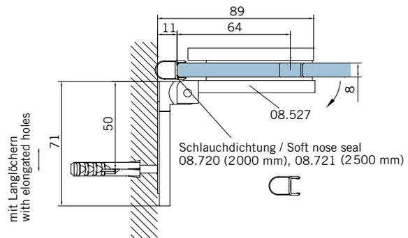
Schlauchdichtung / Soft nose seal
