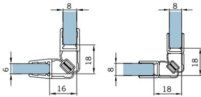
Magnetdichtung 90°, **Acryl transparent**, für 10/12 mm Glas, Lieferung paarweise
