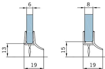
Wasserabweiser, **Acryl transparent**, mit weicher Lippe und langem Glaseinstand, für 10/12 mm Glas, 2.500 mm
