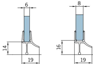
Wasserabweiser, **Acryl transparent**, mit langem Glaseinstand, für 6/8 mm Glas, 2.000 mm
