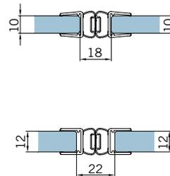
Magnetdichtung 135° für Pendeltüren,
