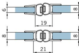
Magnetdichtung 180° für Pendel- und Schiebetüren, **Acryl transparent**, für 10/12 mm Glas, Lieferung paarweise
