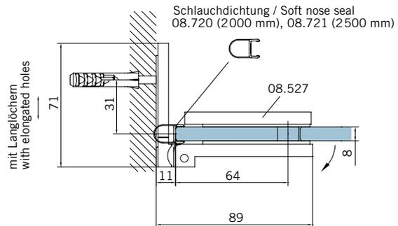
Schlauchdichtung / Soft nose seal
