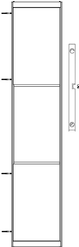
5. Mit einer **Wasserwaage** das **Festelement gleichmäßig zur Pivotür** und zur Wand **ausrichten**. Dabei auf einen gleichmäßigen Luftspalt (siehe Freigabezeichnung) zwischen Festelement und Tür achten.
