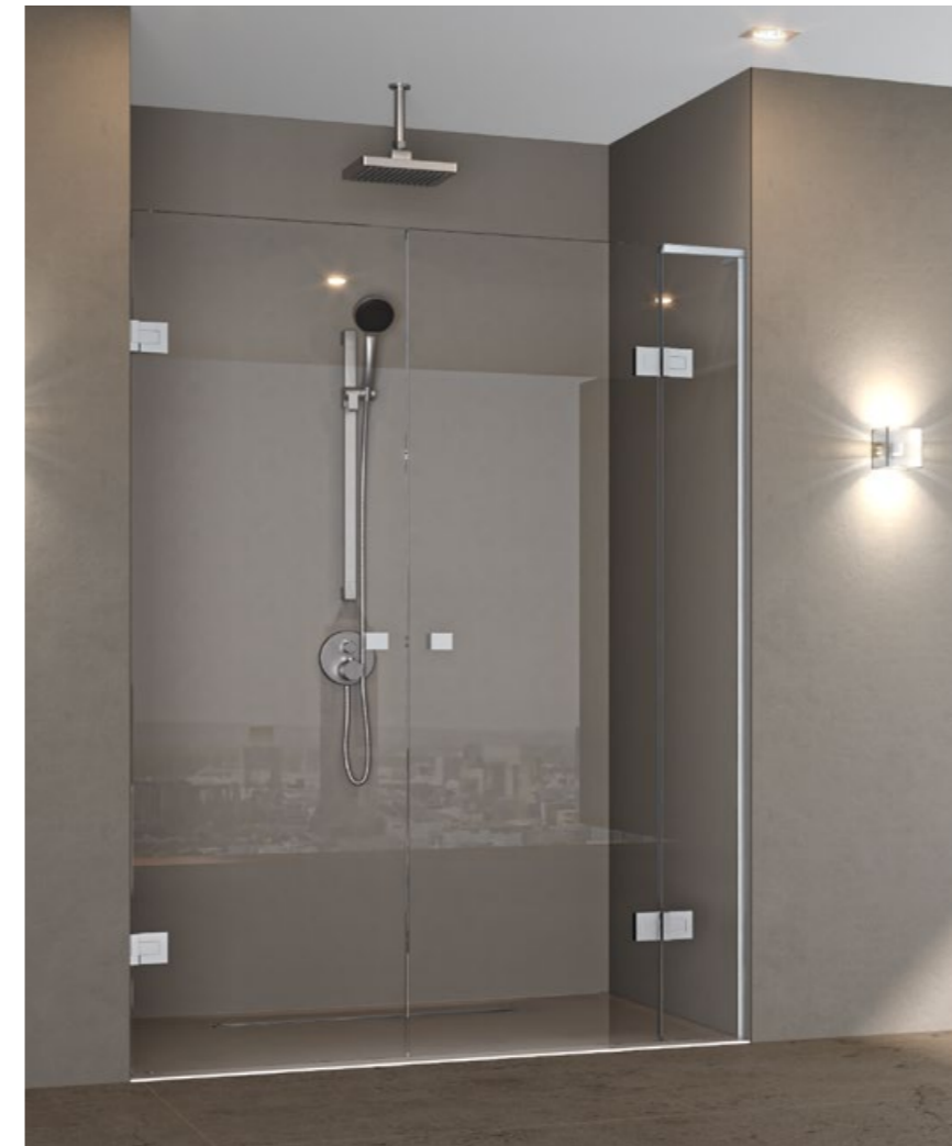
4 TANORA S2 Bei Betätigung heben sich die Duschtüren um 5 mm an und schonen somit die unteren Dichtprofile.
