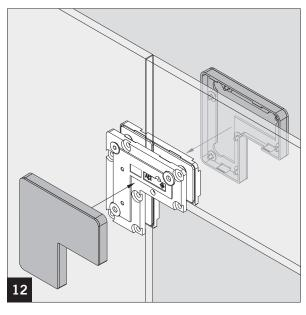
Montageanleitung – Winkelverbinder für Oberlicht und Seitenteil / Mounting instruction – Connector for overpanel and sidelight
