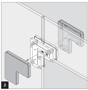
Montageanleitung – Winkelverbinder für Oberlicht und Seitenteil / Mounting instruction – Connector for overpanel and sidelight
