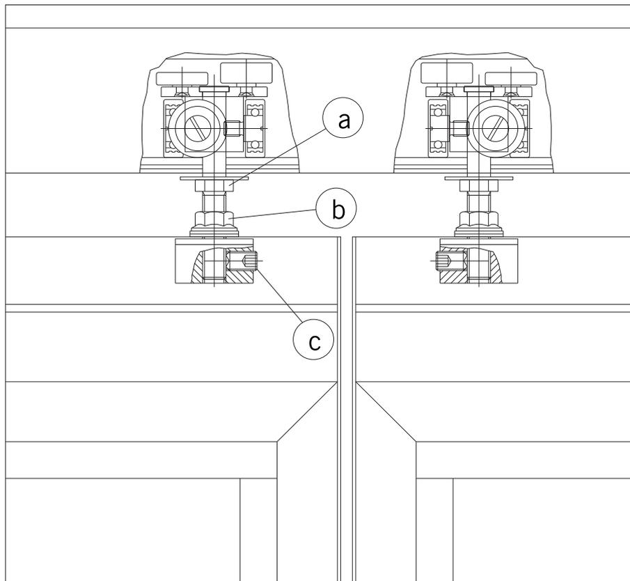
Mit Laufschiene 72 x 75mm
