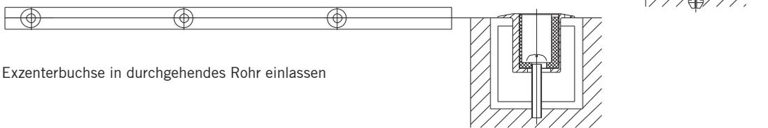
9.2 Exzenterbuchse in durchgehendes Rohr einlassen
